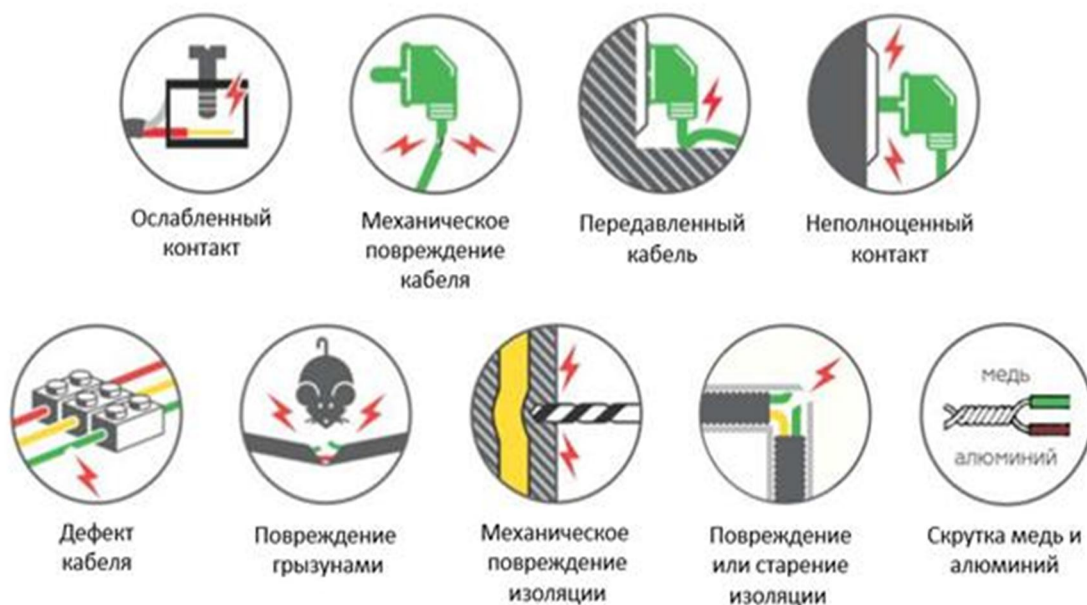
Рисунок 6. Возможные причины искрения в электропроводке
